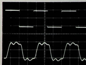
Bild 5. Impulsverhalten bei Rechtecksignalen 2 V RMS (horizontal: 50 \mu\text{s} /Teil)
