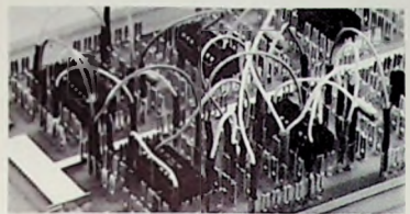
Steckbrett von Spirig für Versuchsaufbauten mit integrierten Schaltungen
